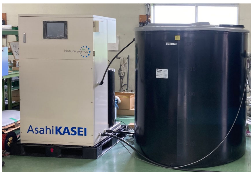
【設置された「Nature Ponics®システム」（左）と分解用タンク（右）】
